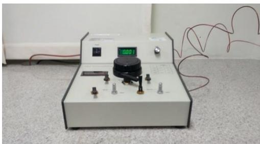
Figura 23 - Equipamento multipicnômetro.
