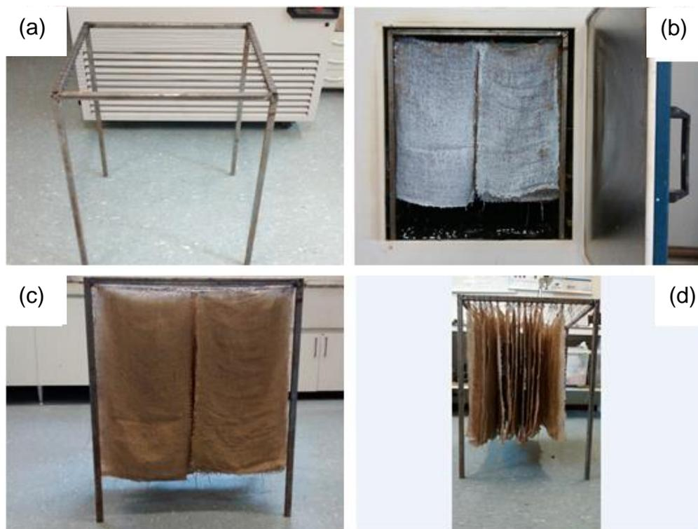
Figura 15 - (a) varal para secagem; (b) fibras impregnadas para secagem na estufa; (c) visão frontal das fibras secas e (d) visão lateral das fibras secas.
