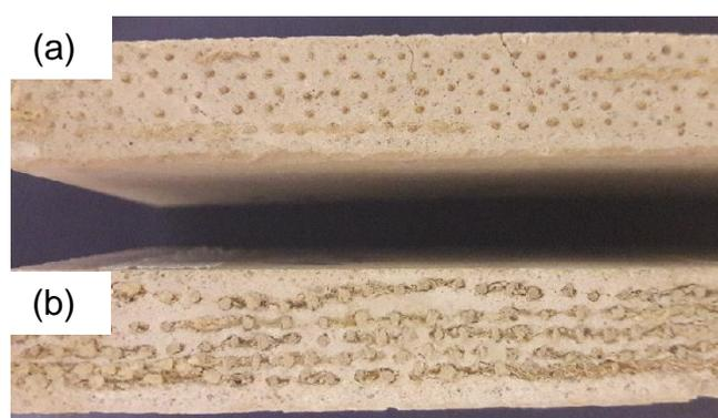
Figura 48 - Compósitos produzidos com a argamassa F3.0-100MC: (a) fibras sem tratamento e (b) fibras tratadas com SBR.
