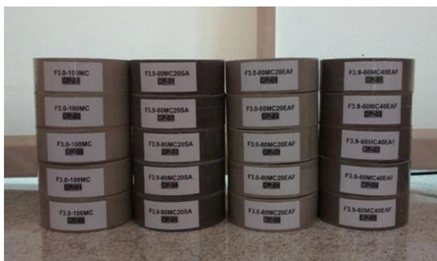
Figura 12 - Corpos de prova de (15 x 5) cm (diâmetro e espessura, respectivamente) para ensaios de permeabilidade ao oxigênio.
