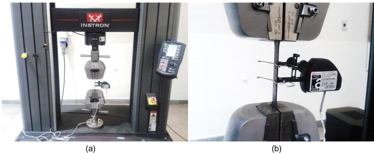
(a) Vista geral do equipamento e (b) detalhe do extensômetro acoplado ao corpo de prova.
