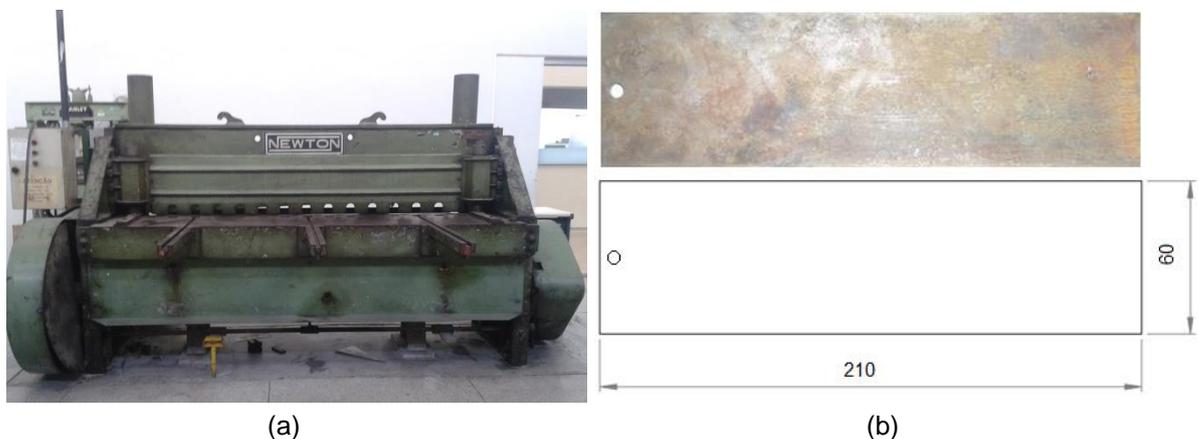
(a) Ghilhotina Newton modelo TM10 e (b) representação esquemática com dimensões em milímetros e imagem da chapa cortada.
