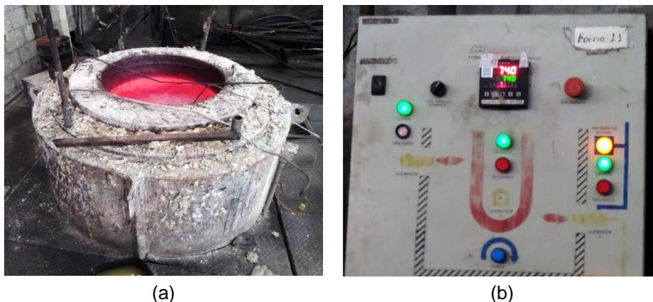
(a) Forno para banho de sal e (b) painel de controle da temperatura do forno.
