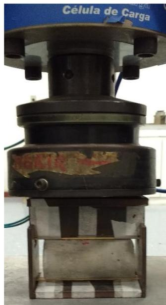
**Figura 5:** Ensaio de tração por compressão diametral utilizando aparato desenvolvido especialmente para o ensaio
