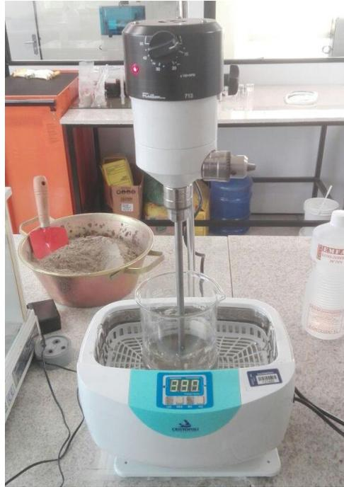
**Figura 4:** Processo de sonificação e mistura do cimento, NTCs e isopropanol
