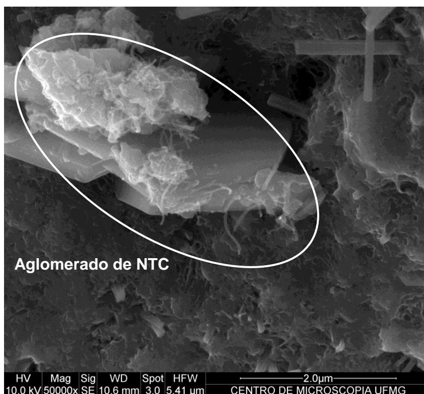
**Figura 37:** MEV de pasta de cimento hidratada com NTC em proporção de 1,00%
