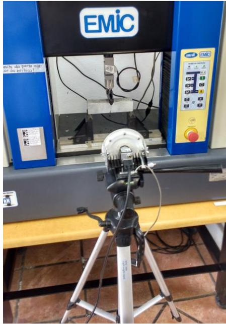
**Figura 7:** Realização do ensaio de flexão
