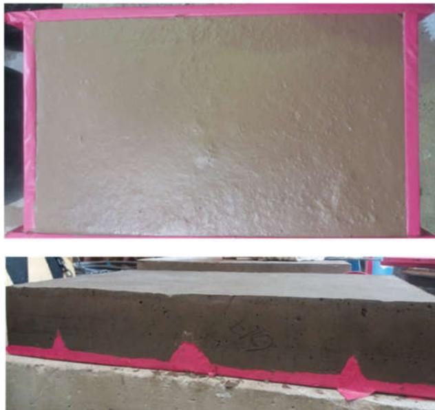
**Figura 17** - Indução da retração com restrição das argamassas segundo a ASTM C1579 (adaptada).
