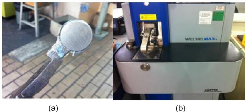
(a) Amostra (b) Espectrômetro de emissão óptica
