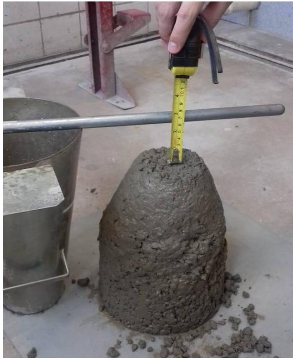
**Figura 25** - Ensaio de abatimento de tronco de cone
