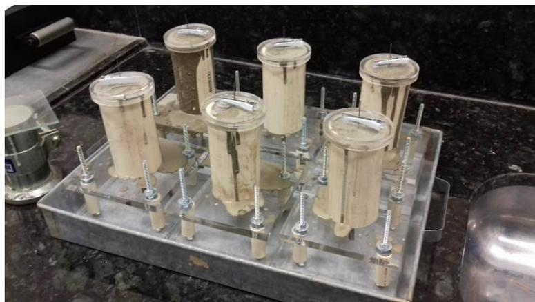
**Figura 21** - Moldagem para ensaio de arrancamento
