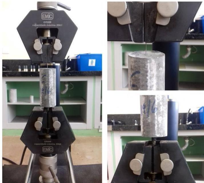
**Figura 26** - Ensaio de arrancamento de fibra
