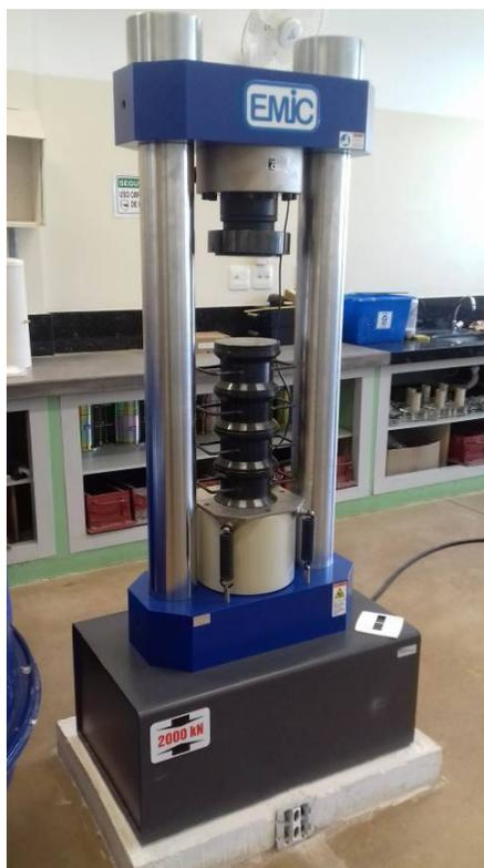
**Figura 18** - Detalhe máquina ensaio para compressão axial
