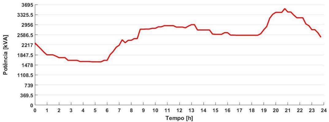
Figura 31 - Curva de Carga Diária Típica do Alimentador BHPM08
