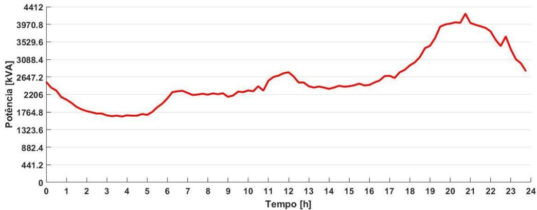
Figura 36 - Curva de Carga Diária Típica do Alimentador BHBN20
