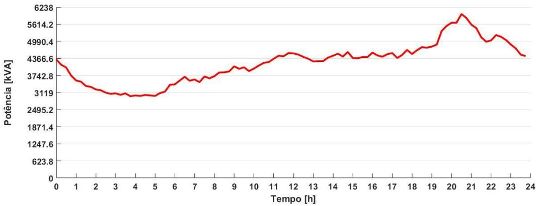
Figura 35 - Curva de Carga Diária Típica do Alimentador BHHR10
