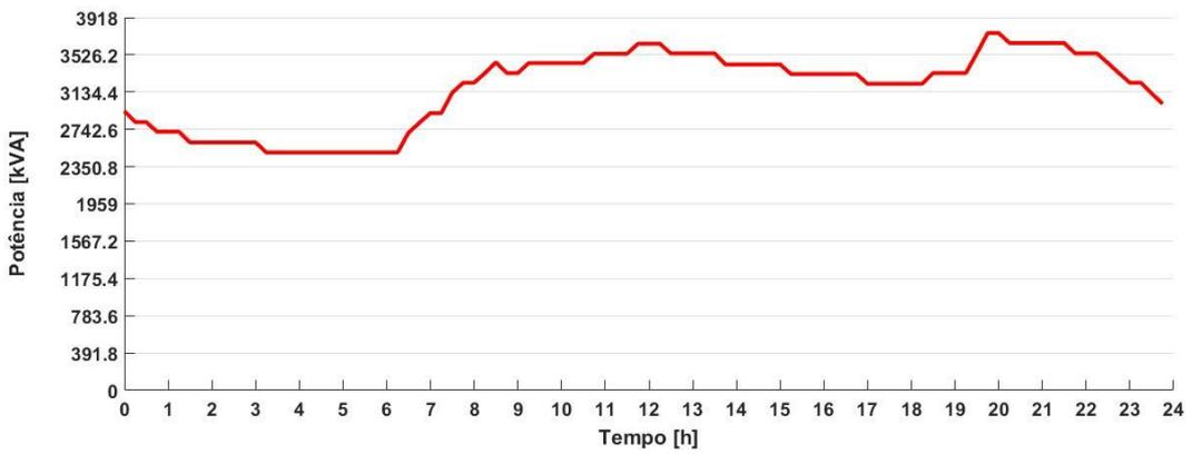
Figura 34 - Curva de Carga Diária Típica do Alimentador BHPM11
