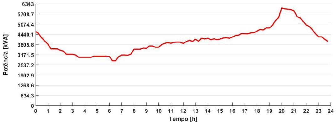
Figura 30 - Curva de Carga Diária Típica do Alimentador BHSN28
