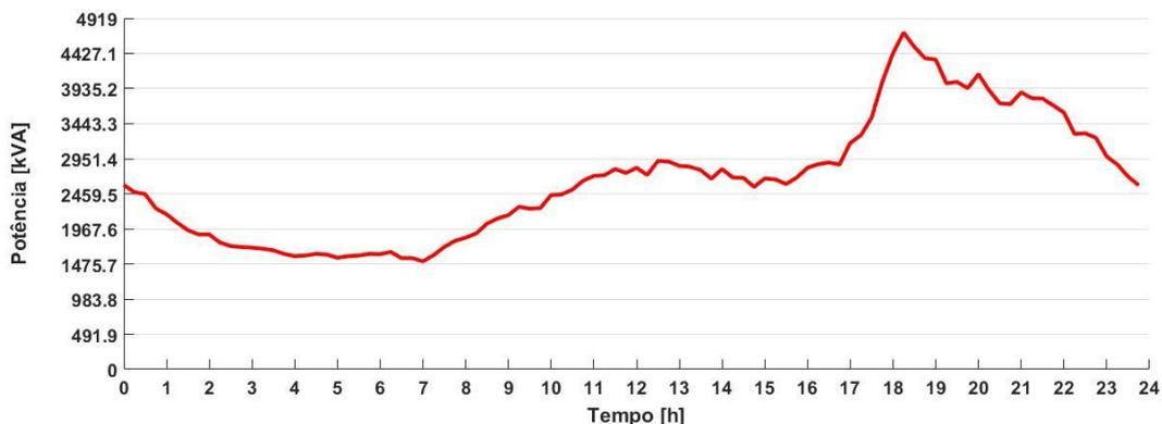
Figura 29 - Curva de Carga Diária Típica do Alimentador BHSN38
