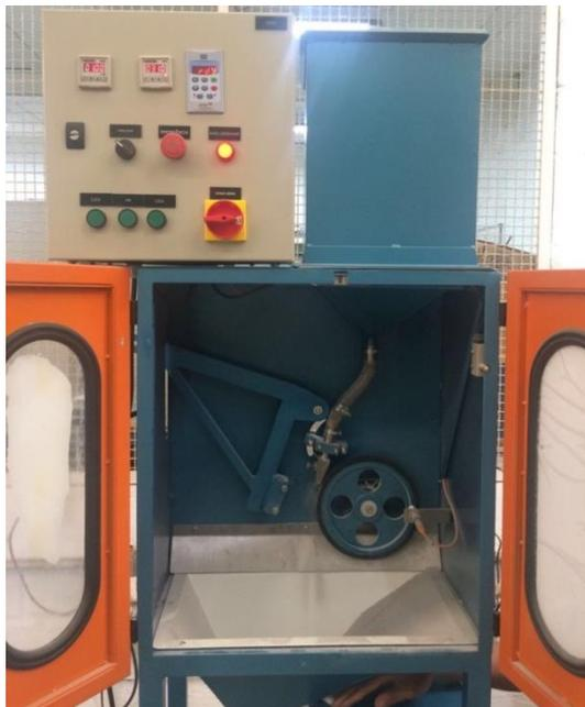
(a) Abrasômetro tipo roda de borracha.
