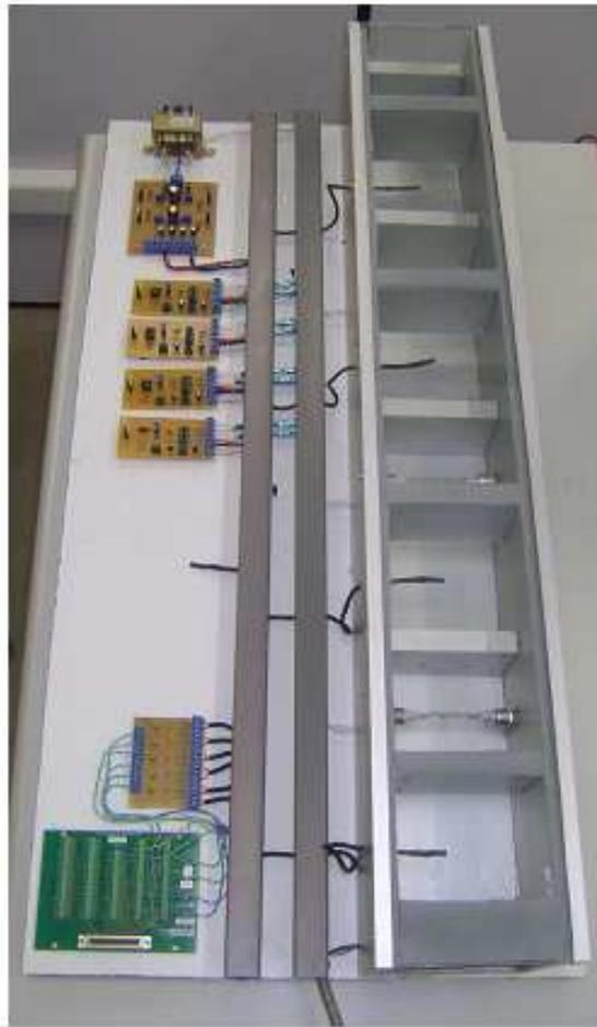
Figura 5.4: Sistema térmico. Adaptada de (Franco *et al.* , 2013)
