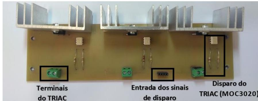
Figura 4.17 – Placa contendo os TRIAC's do sistema de chaveamento do TCSC. Fonte: Autor.
