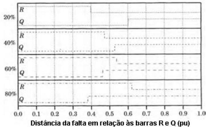
Figura 3.10 - Condução do varistor em função da localização da falta e ao nível de compensação. Fonte: Adaptado de (ANDERSON, 1999).
