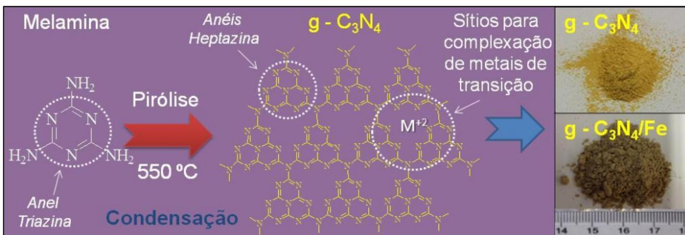
**Figura 6.** Esquema de síntese do  $g\text{-C}_3\text{N}_4$  e imagens dos produtos obtidos no CEFET/MG pelo nosso grupo de pesquisa antes e após dopagem com  $\text{Fe}^{+3}$  [14].
