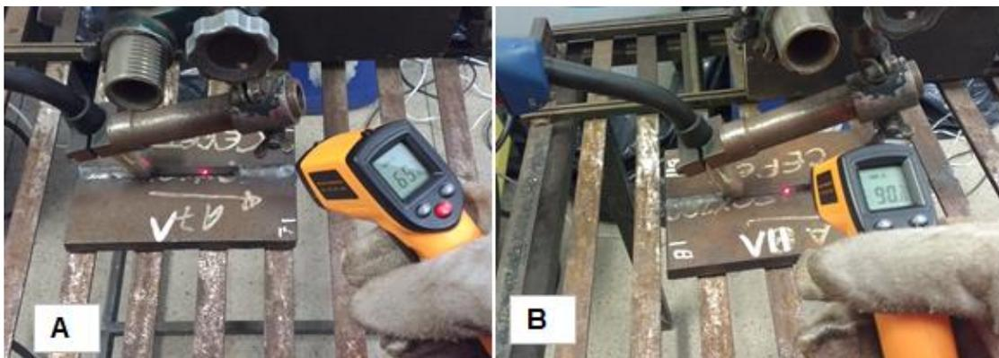
(A) Medição  $T = 65^{\circ}\text{C}$  e (B) Medição  $T = 90^{\circ}\text{C}$
