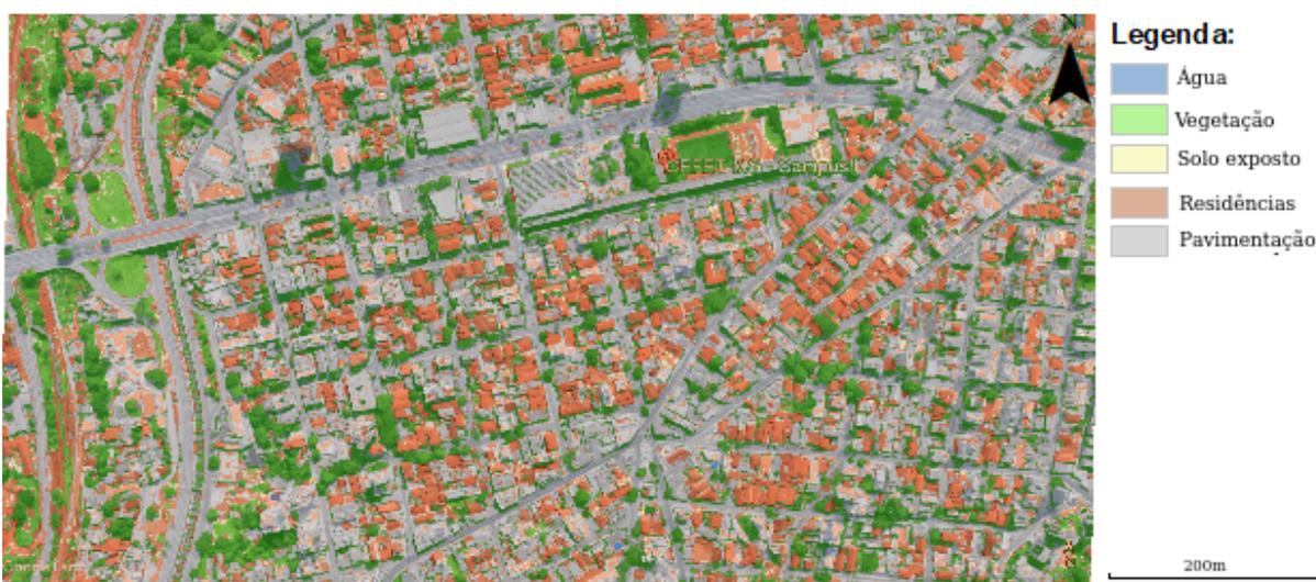
Figura 2 – Área 2. Imagem extraída do software Google Earth<sup>®</sup> sob imagem da mesma área classificada no ArcGIS<sup>®</sup>.
