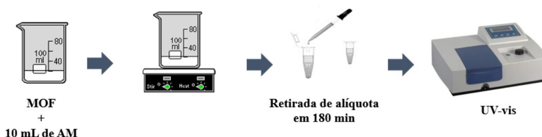
**Figura 12.** Esquema para adsorção do azul de metileno (AM).
