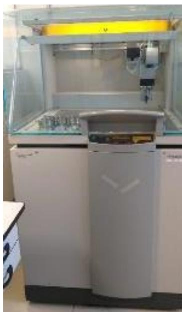
**Figura 19** - Equipamento de FRX utilizado nas análises químicas. Fonte: Própria.
