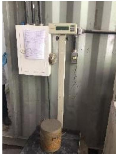
**Figura 35** - Determinação do teor de ar aprisionado e da massa específica.
