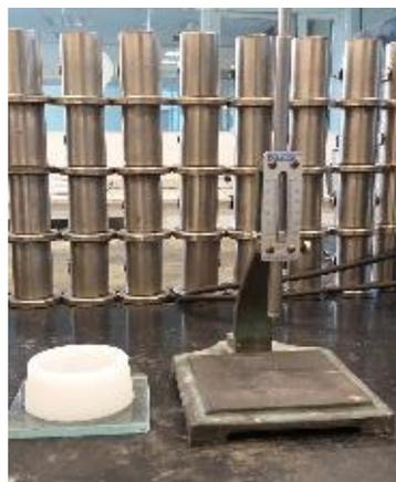
**Figura 26** - Aparelho de Vicat utilizado para determinação dos tempos de pega. Fonte: Própria.
