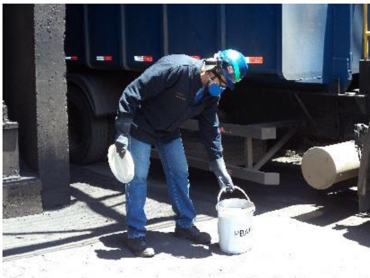
**Figura 13** - Coleta do pó do balão de alto-forno. Fonte: Própria.
