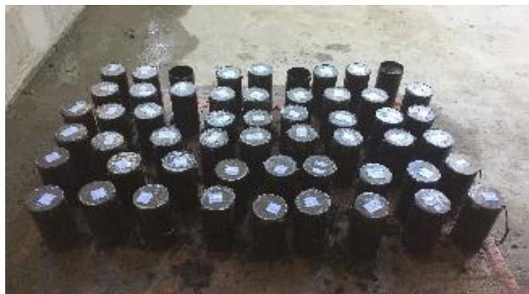
**Figura 36** - Conjunto de 54 corpos de prova moldados e identificados. Fonte: Própria.
