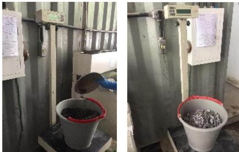
**Figura 32** - Pesagem do cimento e dos agregados graúdo e miúdo. Fonte: Própria.
