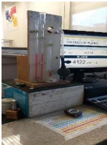
**Figura 24** - Ensaio para determinação de finura Blaine em andamento. Fonte: Própria.
