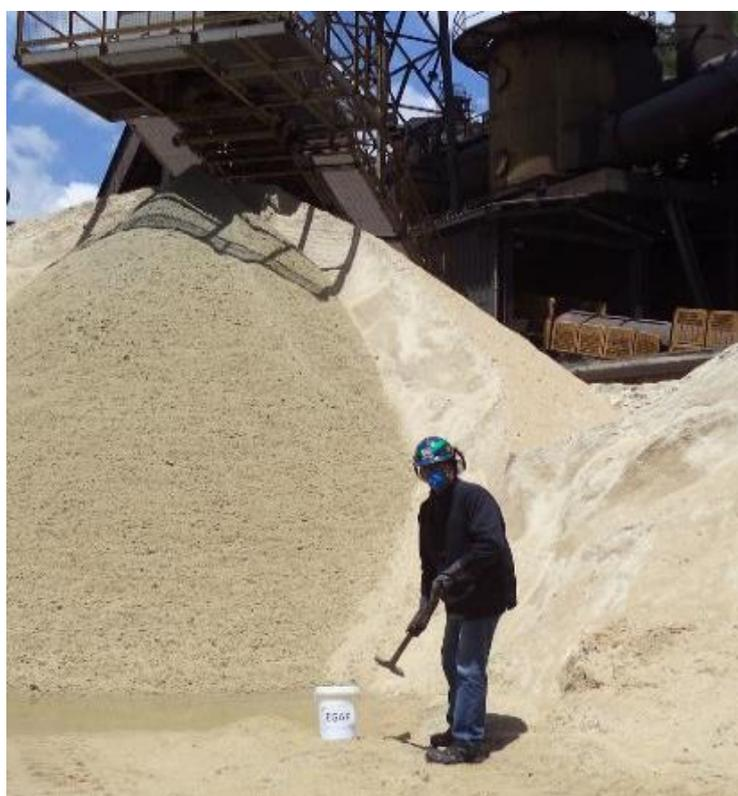
**Figura 12** - Coleta da escória granulada de alto-forno. Fonte: Própria.
