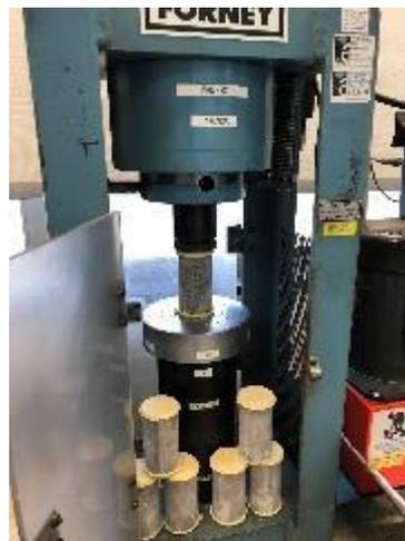
**Figura 29** - Ensaio de ruptura à compressão axial dos corpos de prova das argamassas em andamento. Fonte: Própria.
