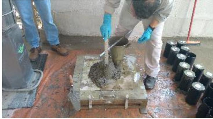
**Figura 34** - Determinação da consistência pelo abatimento do tronco de cone.
