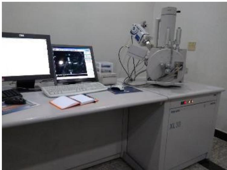
**Figura 20** - Equipamento de MEV utilizado nas análises de microestrutura. Fonte: Própria.
