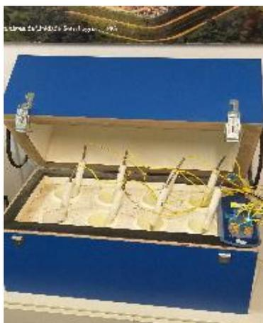
**Figura 27** - Calorímetro semi-adiabático utilizado para determinação do calor de hidratação. Fonte: Própria.
