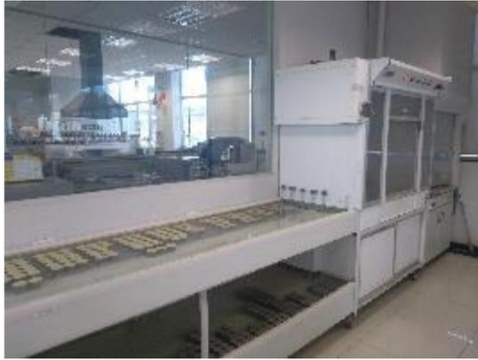
**Figura 28** - Câmara úmida e tanque de imersão para cura dos corpos de prova das argamassas. Fonte: Própria.
