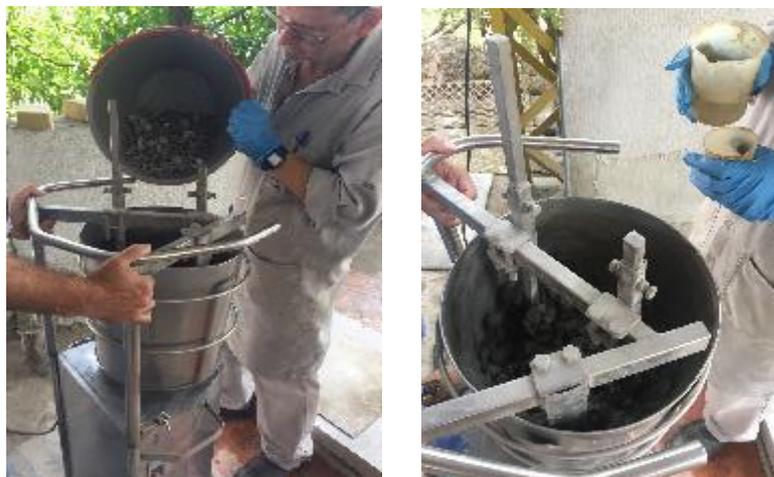
**Figura 33** - Mistura dos materiais para a produção dos concretos. Fonte: Própria.
