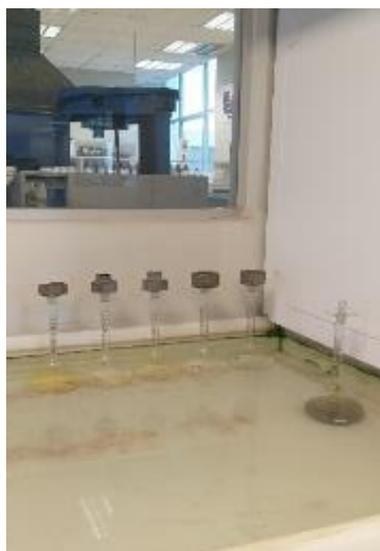
**Figura 23** - Ensaio para determinação de massa específica em andamento. Fonte: Própria.
