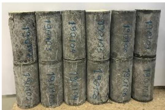
**Figura 30** - Conjunto dos corpos de prova após realização dos ensaios à compressão axial. Fonte: Própria.
