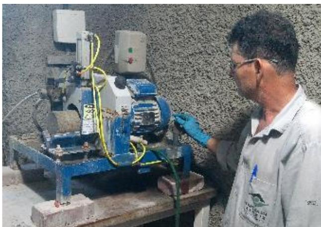
**Figura 37** - Processo de retificação das bases dos corpos de prova. Fonte: Própria.
