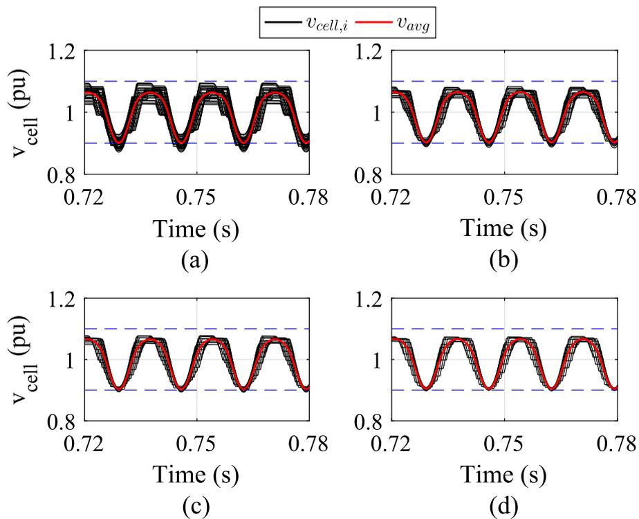
Figure 19 – DSCC-MMCC cell voltages detail in the upper arm of phase A for inductive operation: (a)  $C_{17}$ ; (b)  $C_{33}$ ; (c)  $C_{45}$ ; (d)  $C_{65}$ .
