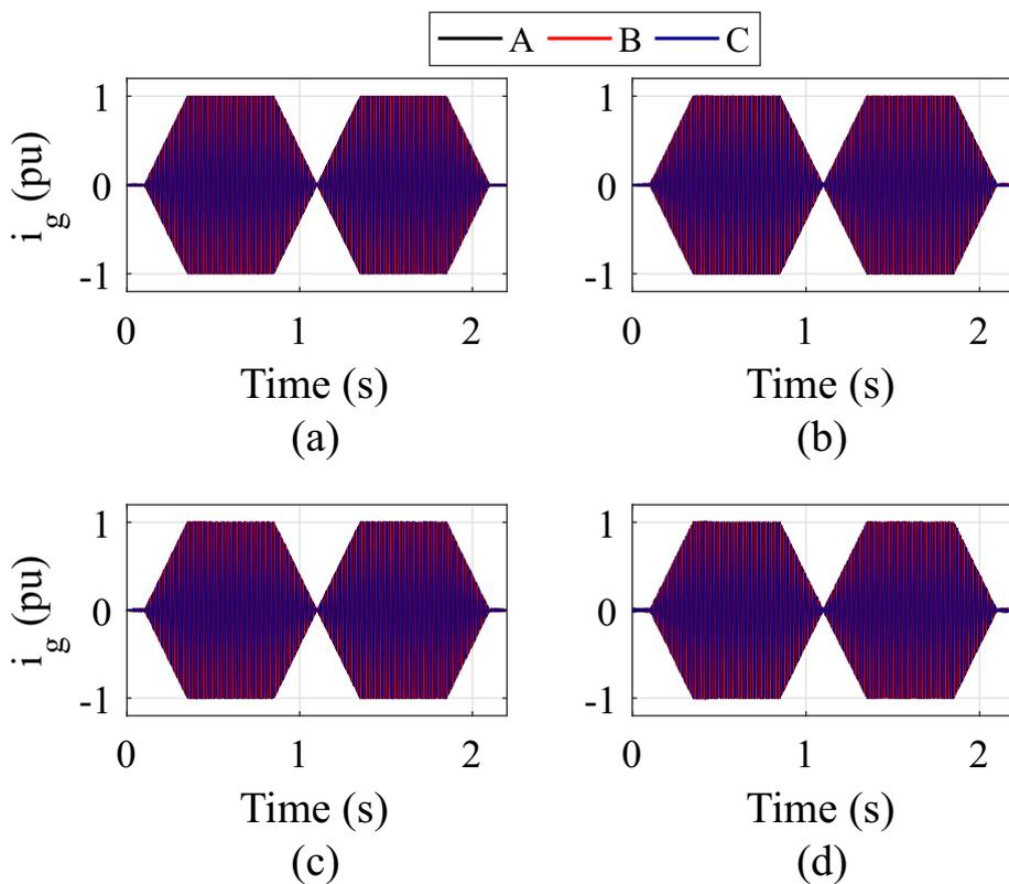
Figure 16 – Grid currents dynamic behavior of DSCC-MMCC: (a)  $C_{17}$ ; (b)  $C_{33}$ ; (c)  $C_{45}$ ; (d)  $C_{65}$
