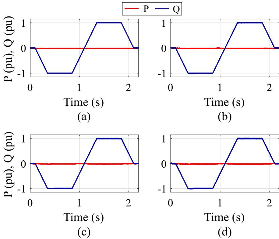
Figure 15 – Instantaneous active and reactive power of DSCC-MMCC: (a)  $C_{17}$ ; (b)  $C_{33}$ ; (c)  $C_{45}$ ; (d)  $C_{65}$
