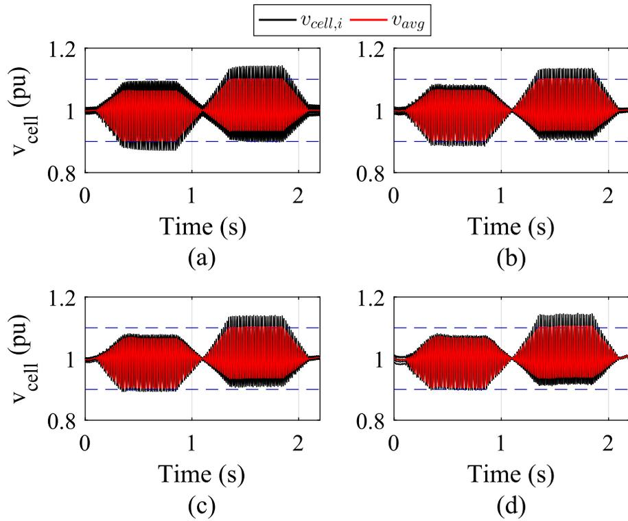
Figure 18 – DSCC-MMCC cell voltages in the upper arm of phase A: (a)  $C_{17}$ ; (b)  $C_{33}$ ; (c)  $C_{45}$ ; (d)  $C_{65}$ .
