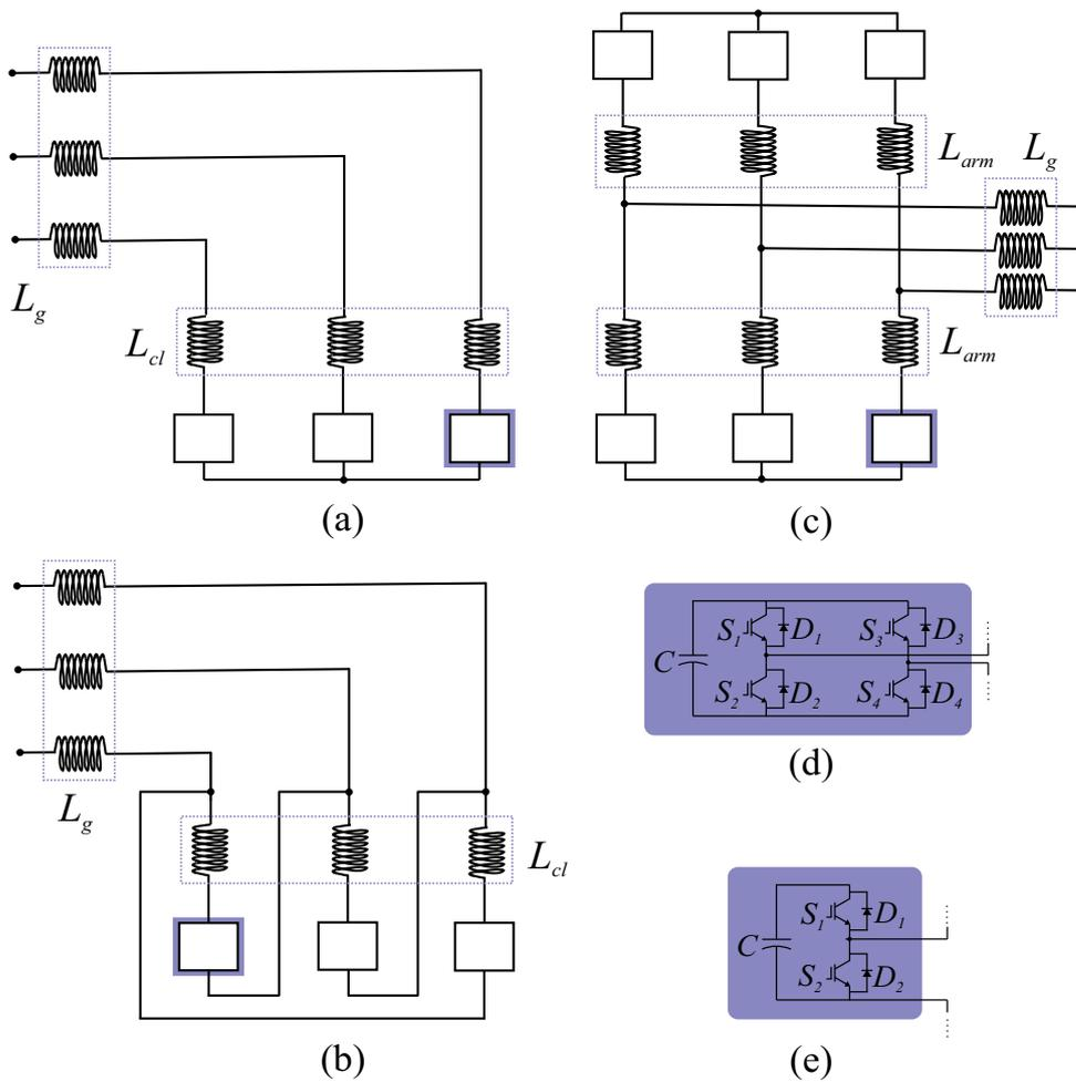
Figure 6 – MMCC configuration. (a) SSBC; (b) SDBC; (c) DSCC or DSBC; (d) Bridge Cell; (e) Chopper Cell.
