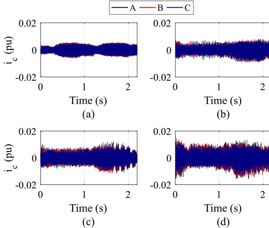
Figure 17 – DSCC-MMCC circulating currents: (a)  $C_{17}$ ; (b)  $C_{33}$ ; (c)  $C_{45}$ ; (d)  $C_{65}$ .
