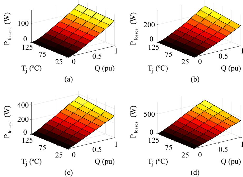
Figure 33 – Power losses of IGBT  $S_1$  for the cases: (a)  $C_{17}$ ; (b)  $C_{33}$ ; (c)  $C_{45}$ ; (d)  $C_{65}$ .
