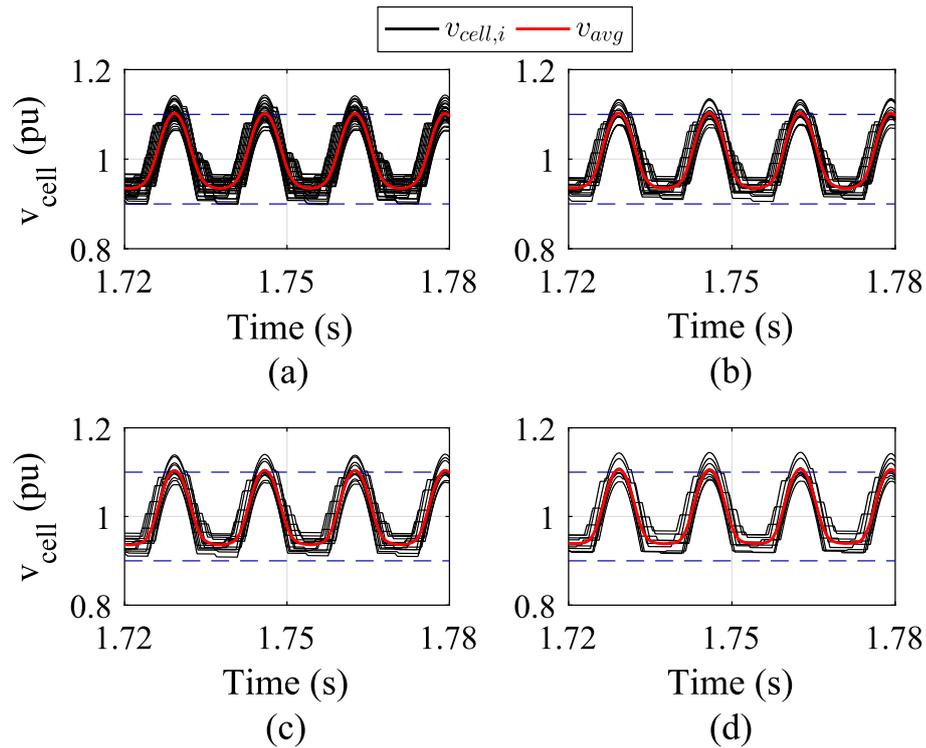
Figure 20 – DSCC-MMCC cell voltages detail in the upper arm of phase A for capacitive operation: (a)  $C_{17}$ ; (b)  $C_{33}$ ; (c)  $C_{45}$ ; (d)  $C_{65}$ .
