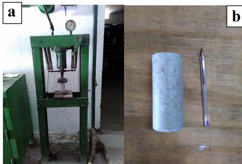
(a) Prensa hidráulica, (b) Corpo de prova 0G.
