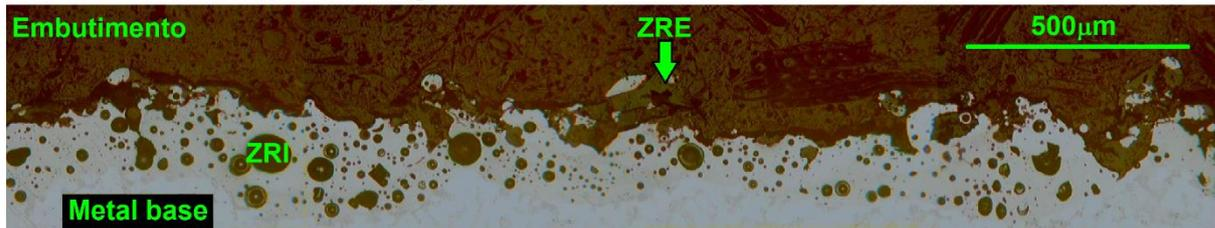
Figura 42 – Imagem de MEV da camada modificada da amostra UreiaPos5A
