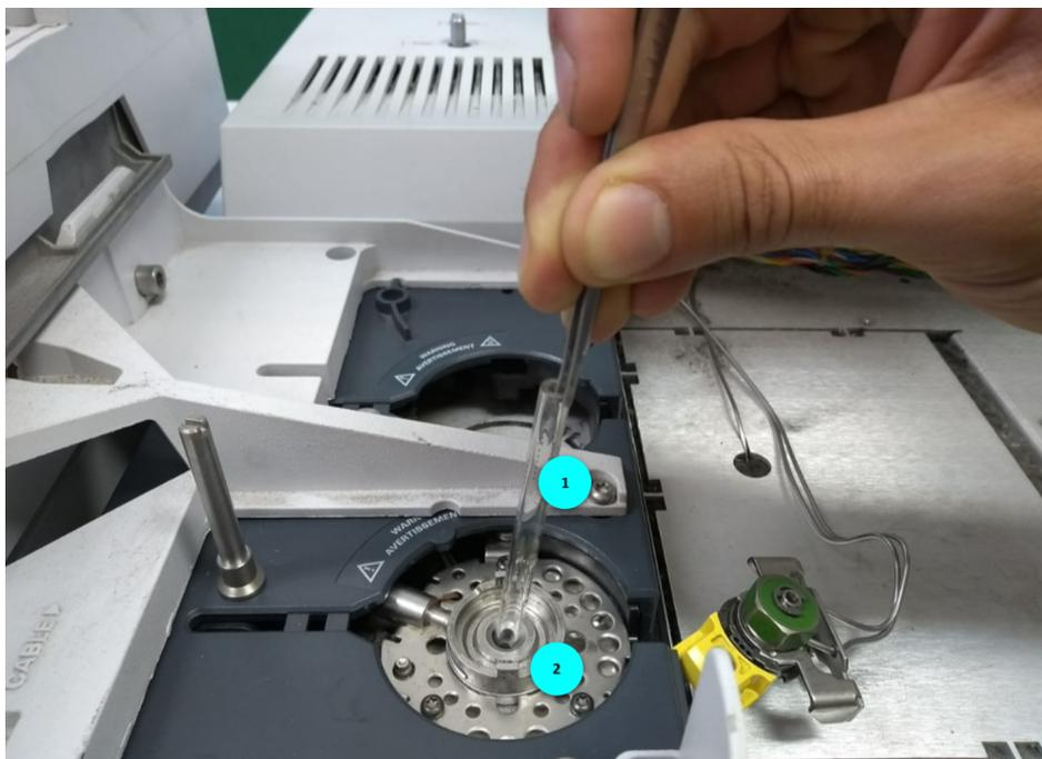
Figura 26 – Processo de inserção manual do *liner* na câmara de injeção do cromatógrafo a gás, destacando 1) *liner* sendo posicionado e 2) câmara de injeção do cromatógrafo a gás.
