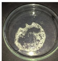
Figura 30 – Amostra de poliacrilato após teste de aquecimento em estufa.
