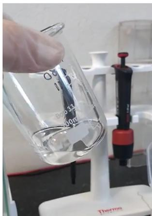
Figura 20 – Solução de poli(metil metacrilato) 10% m/v em diclorometano.
