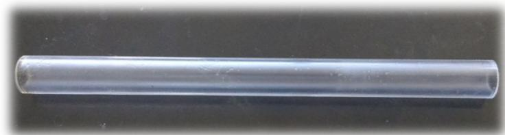
FIGURA 47. FOTOGRAFIA DO PROTÓTIPO REVESTIDO COM PDMS UTILIZADO PARA AMOSTRAGEM DINÂMICA E PRÉ-CONCENTRAÇÃO DE ANALITOS ORGÂNICOS EM SOLUÇÃO AQUOSA. A ESPESSURA DO REVESTIMENTO FOI DE 80  $\mu\text{M}$ .
