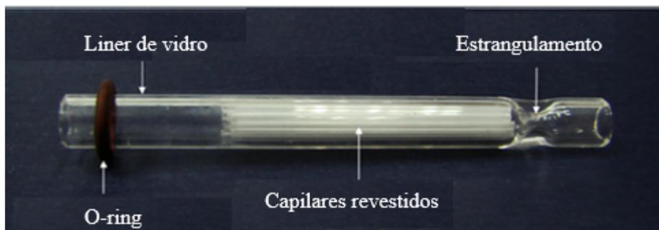
**FIGURA 35.** ACIT-SPME PARA AMOSTRAGEM DE POLUENTES EM AMOSTRAS DE ÁGUA [34].
