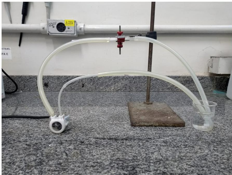
**FIGURA 40.** BOMBA PERISTÁLTICA DE BANCADA UTILIZADA PARA A AMOSTRAGEM DOS COMPOSTOS ORGÂNICOS NA PRIMEIRA ETAPA DO EXPERIMENTO.
