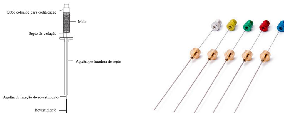
**FIGURA 6.** VISÃO ESQUEMÁTICA DA FIBRA DE SPME. ADAPTADO DE [2]. FIBRAS DE SPME COM DIFERENTES TIPOS DE REVESTIMENTO CODIFICADOS POR CORES. FONTE: PAL SYSTEM: INGENIOUS SAMPLE HANDLING.
