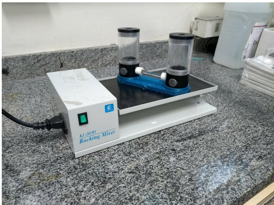
**FIGURA 41.** AMOSTRADOR DESENVOLVIDO PELO LABORATÓRIO INTECH DO CEFET-MG UTILIZADO PARA A AMOSTRAGEM DURANTE A SEGUNDA ETAPA DO EXPERIMENTO QUE SUBSTITUIU A UTILIZAÇÃO DA BOMBA PERISTÁLTICA. OS RESERVATÓRIOS FORAM UTILIZADOS PARA O ACONDICIONAMENTO DE 40,00 ML DAS SOLUÇÕES A CADA AMOSTRAGEM REALIZADA E O SISTEMA FOI COLOCADO EM UMA PLATAFORMA EM MOVIMENTO DE MODO A GARANTIR A ABSORÇÃO COMPLETA DOS ANALITOS PELO REVESTIMENTO ATÉ QUE O EQUILÍBRIO DE PARTIÇÃO FOSSE ATINGIDO.
