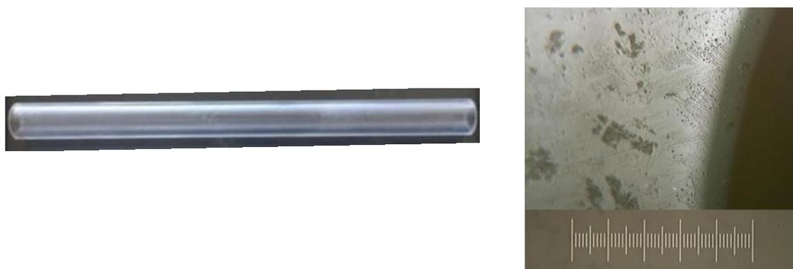
**Figura 36** Fotografia de perfil de um liner de vidro. No detalhe foto obtida pelo microscópio Digital Electronic Magnifier, representando parte do revestimento interno do liner com o polímero PDMS.
