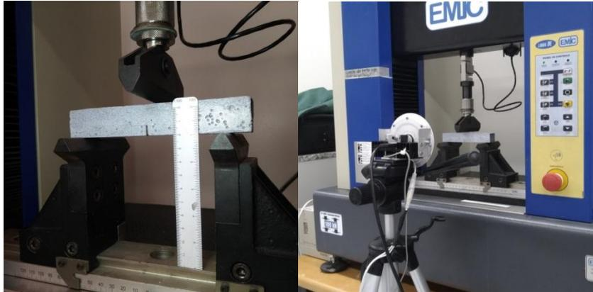
Simultaneamente às imagens geradas pela câmera *Basler acA3800*, uma *webcam* da marca *C3 Tech*, modelo *wb2105-p*, registrou a força aplicada pelo equipamento no corpo de prova, também até atingir a ruptura, como mostra a Figura 26.
