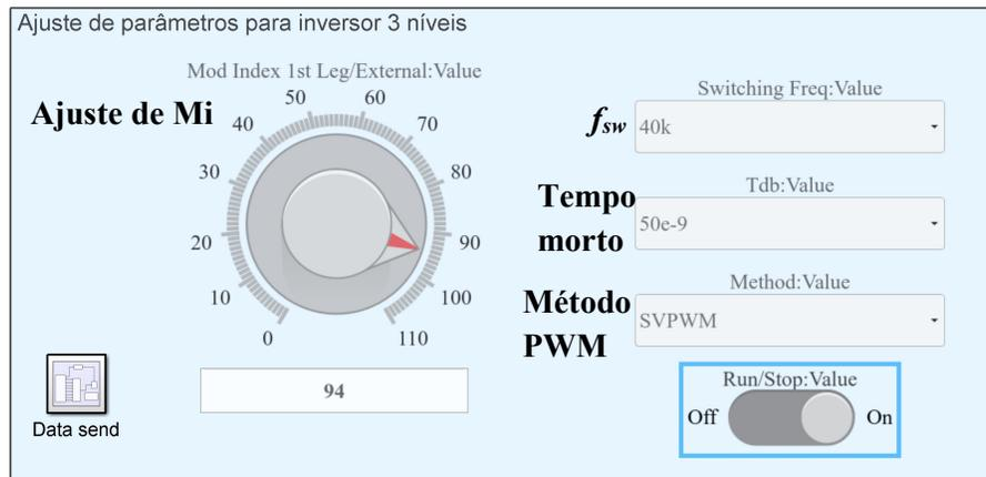
Figura 4.30 – Interface gráfica de controle do conversor.
