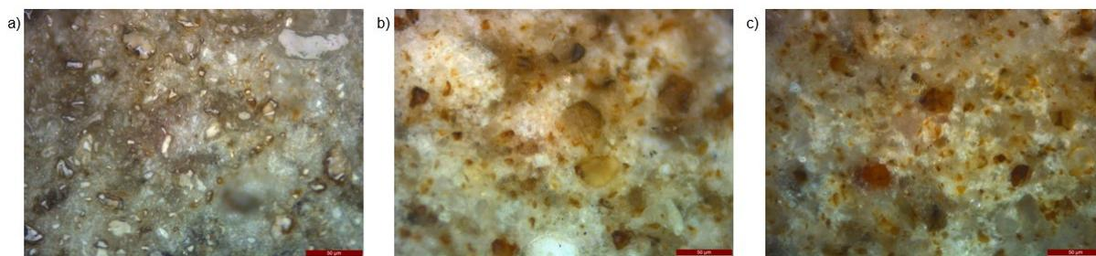
**Figura 4. 5:** Imagens em um microscópio óptico, com ampliações de 50 µm para avaliação da superfície das pastas das pastas (a) REF, (b) ISO-0,05 e (c) ISO-0,10
