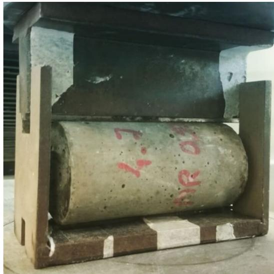
**Figura 2. 5:** Aparato utilizado para o ensaio de tração diametral
