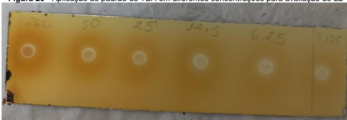
A mancha correspondente ao limite da especificação (260 g/L) apresentou tamanho, cor e intensidade facilmente detectados visualmente. A concentração de 3,125 g/L foi definida como LD para esse método, uma vez que a mancha obtida apresentou intensidade fraca. Como a concentração definida para LD está muito abaixo do limite de especificação (260 g/L), que será utilizado na rotina de análise do produto, o método mostrou-se satisfatório.
