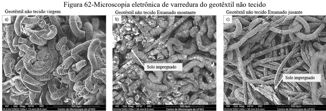
(a) Geotêxtil não tecido virgem; (b) geotêxtil não tecido colmatado por material particulado na face a montante; (c) Fibras do geotêxtil não tecido impregnado na face a jusante.
