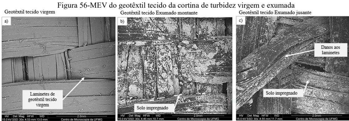
(a) Geotêxtil tecido virgem; (b) Geotêxtil tecido exumado impregnado com solo na face montante; (c) Geotêxtil tecido exumado impregnado com solo com fluxo passante.
