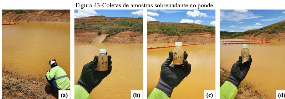
a) Coleta de amostra manual; b) Ponto de coleta A, a montante das cortinas; c) Ponto de coleta B entre as cortinas; d) Ponto de coleta C, a jusante das cortinas.
