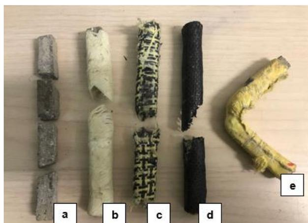
a- CP sem revestimento; b- FV; c- FH; d- FC; e- FA
