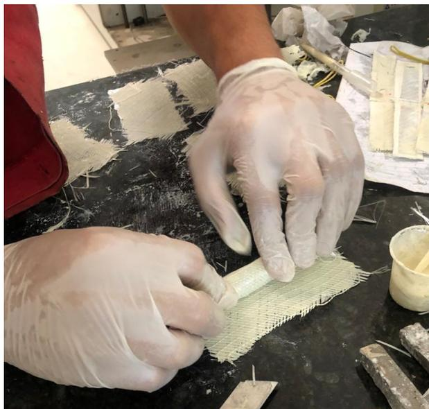
**Figura 4.3 – Processo de laminação dos CPs**
