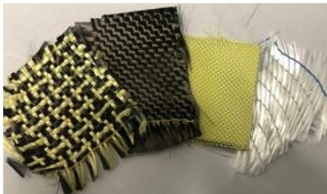
**Figura 4.1 – Fibras utilizadas na confecção dos compósitos**
