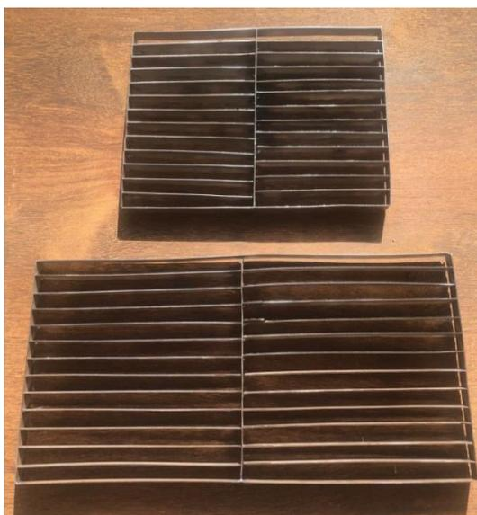
**Figura A.1 – Moldes para confecção dos CPs de concreto**
