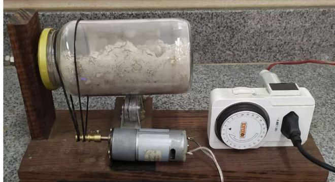
**Figura 14** – Misturador de bolas utilizado para homogeneização dos componentes sólidos.
