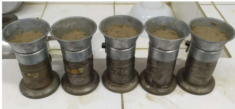
**Figura 10** – Corpos de prova após o adensamento.
