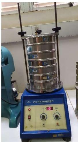
**Figura 8** - Imagem do agitador eletromagnético de peneiras redondas, empregado para a análise granulométrica da amostra de agregado.
