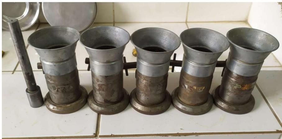
**Figura 9** - Moldes de aço usados para a produção dos corpos de prova.
