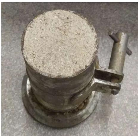
**Figura 11** – Corpo-de-prova nivelado.
